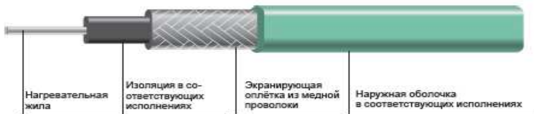
Рис. №2 – конструкция резистивного нагревательного кабеля HLLP
