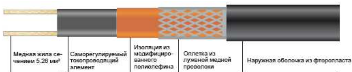
Рис. №1 – конструкция саморегулирующейся нагревательной ленты HLE
